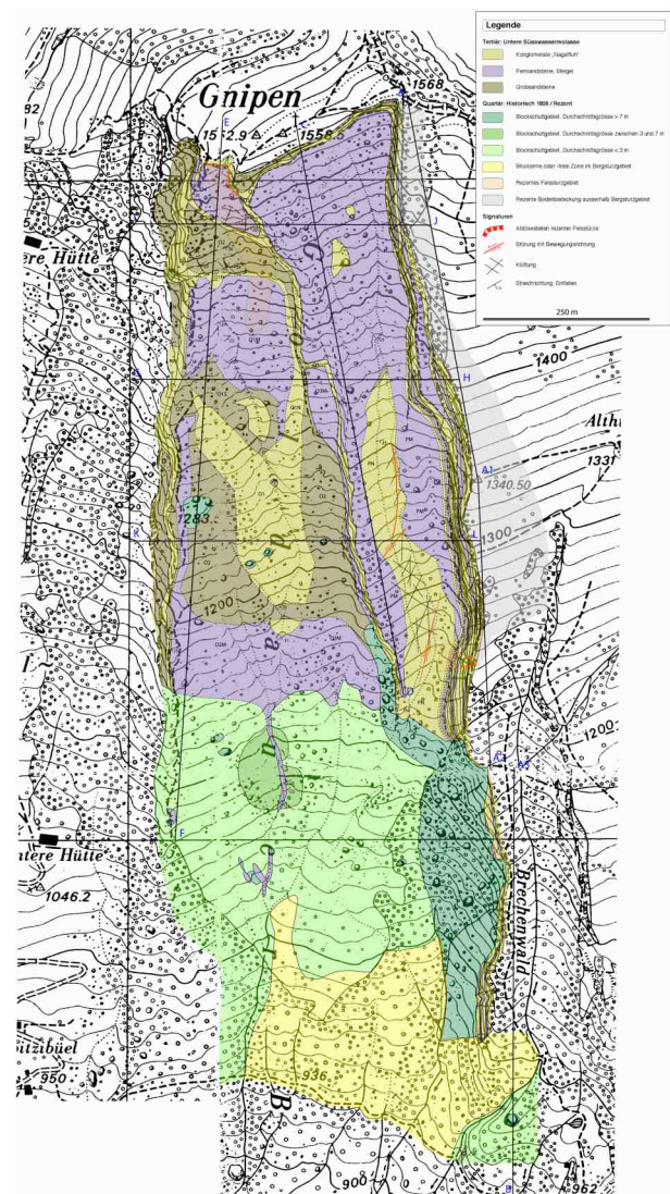
Fig. 13: Detailkarte des Abriss- und Gleitbereichs (M 1:5.000) des Goldauer Bergsturzes (BERNER 2004). Fig. 13: Detailed map of the scarp region and sliding plane (1: 5,000) of the Goldau rock slide (BERNER 2004).
