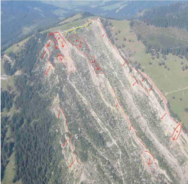
Fig. 14: Luftansicht einiger aktueller und potentieller Ereignisse mit hohem Gefahrenpotential in der Abrissnische des Goldauer Bergsturzes (Luftbild: Sturzenegger).
