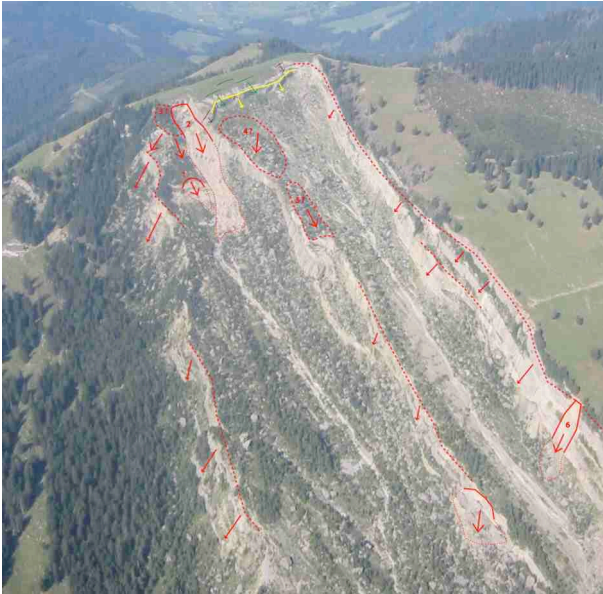
Fig. 14: Luftansicht einiger aktueller und potentieller Ereignisse mit hohem Gefahrenpotential in der Abrissnische des Goldauer Bergsturzes (Luftbild: Sturzenegger). Fig. 14: Aerial view of actual and potential events with high hazard impact in the scarp region of the Goldau rock slide (Aerial photo: Sturzenegger).
